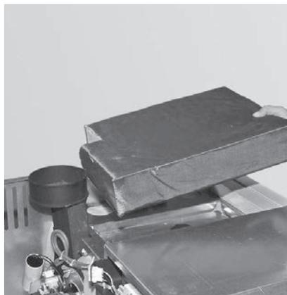
Fig. 34 Rimuovere l'isolamento
