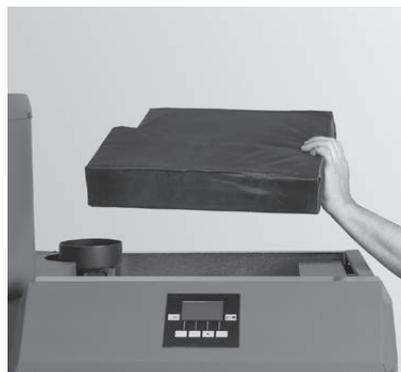
Fig. 134 Applicare l'isolamento
